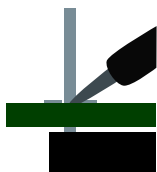
Lötcolben an Draht und Platine halten
